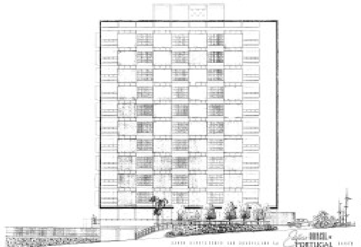
Fig. 17- Elevação da avenida Nações Unidas: Edifício Brasil Portugal. Em 1962 foram acrescentados no projeto mais dois pavimentos, comparar com a figura ao lado. Fonte: Arquivo Prefeitura Municipal de Bauru
