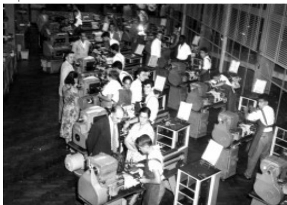
Fig. 35 e 36 - Vistas internas da oficina. Observar os grandes vãos envidraçados projetados para obter iluminação e ventilação naturais. Fonte: Arquivo SENAI Bauru e R.J.G. Tibau, respectivamente.
